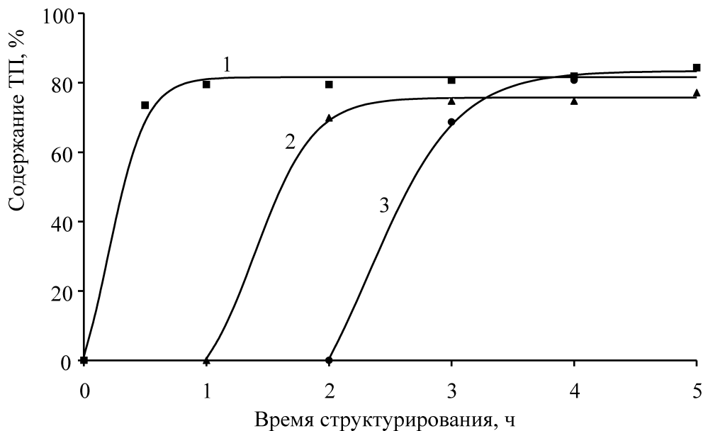
Рис. 4. Зависимость содержания ТП от времени структурирования ОБ при введении [ML 3 Br 3 ]: 1 — [CoL 3 Br 2 ]; 2 — [ZnL 3 Br 2 ]; 3 — KRASOL LB-2000
