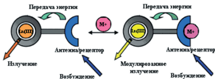
Рис. 2. Схематическое изображение флуоресцентного сенсора на основе комплексного соединения \text{Ln(III)} для определения катионов
