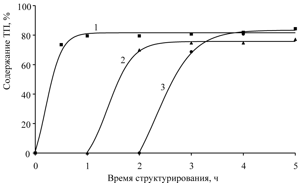
Рис. 4. Зависимость содержания ТП от времени структурирования ОБ при введении [ML_3Br_2] : 1 — [CoL_3Br_2] ; 2 — [ZnL_3Br_2] ; 3 — KRASOL LB-2000
