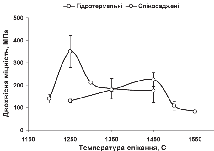
Рис. 3. Міцність зразків електроліту з нових порошоків 10Sc1CeSZ UKR, виготовлених методами гідротермальним та співосадженням в залежності від температури спікання
