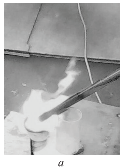
Рис.1. Горіння «метилацетату» в алундовому тиглі а) без дії і б) при дії стримерів.
