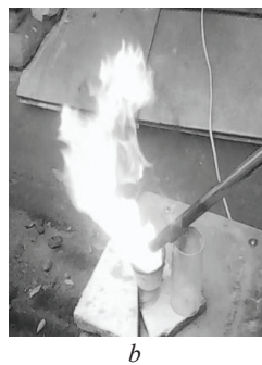
Рис.1. Горіння «метилацетату» в алундовому тиглі а) без дії і б) при дії стримерів.
